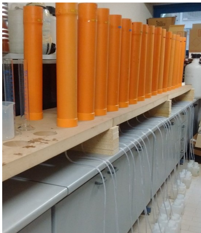
Figura 4. Attrezzatura utilizzata per gli esperimenti in microcosmo dei diversi concimi su 2 tipologie di terreni.
